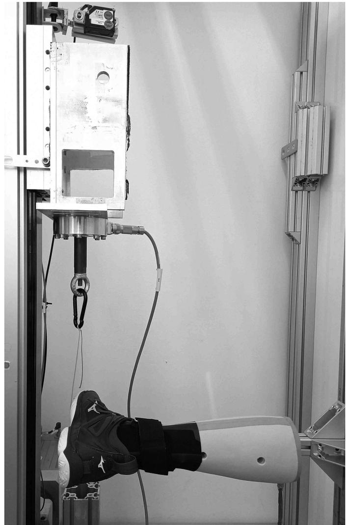
図1. 機械的テストは、さまざまな装具条件で人工足首(右下肢と足を表す)を使用して実行されました。内反は、足の側面に接続されたロープを上方に引っ張ることによって誘発されます。すべてのブレースは、生体力学的テスト時と同じ靴を使用してテストされました。結果は、条件ごとに3回の試行の平均を表します。
